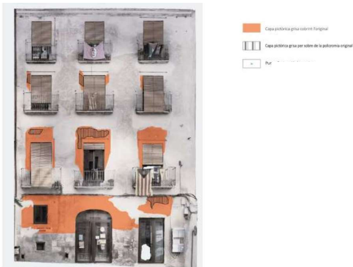
PLÀNOL 2. PLÀNOL DE PATOLOGIES DE LA CAPA PICTÒRICA I LOCALITZACÓ DE CALES
