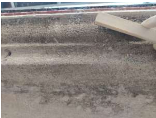
Fig.65. Raspallat un cop ha actuat el biocida
