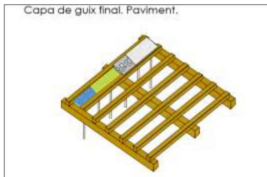
Pas 6: capa uniforme, aplicada per colada, mínimament reglejada i acabat rugós.
