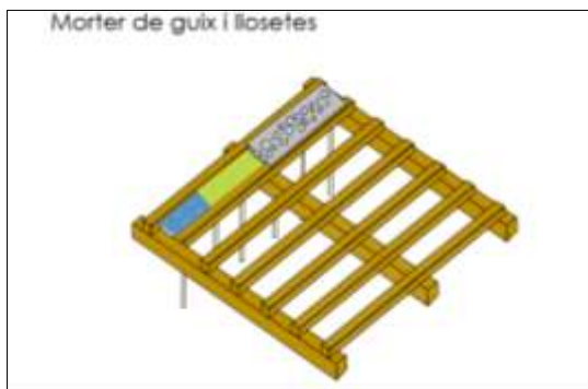
Pas 5: capa gruixuda (entre 7 i 15 cm) de morter de guix. Reblert de llosetes.
